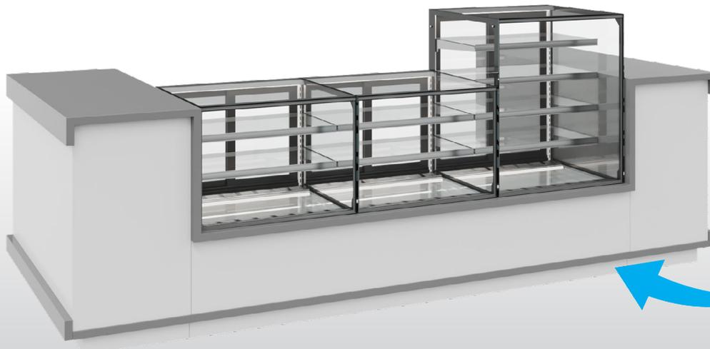
При встраивании витрин необходимы вентиляционные отверстия в барной стойке, на расстоянии от пола 200 мм.
